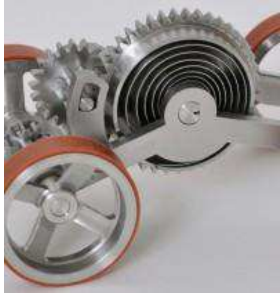
Abbildung 9: Feder im Aufziehmotor
